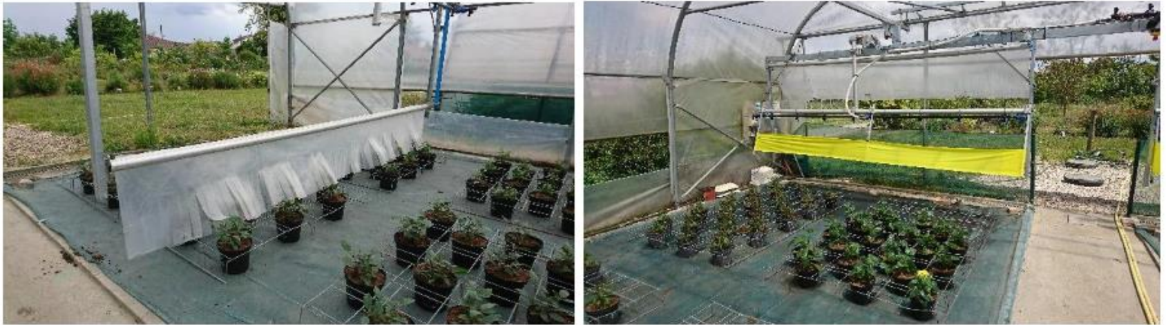
FIGURE 4 : CHARIOT DOUBLE RAIL POLYVALENT ARROSAGE/REGULATION/PIEGEAGE COMMERCIALISE PAR PYRENE AUTOMATION
