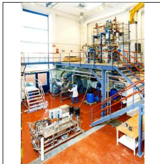
Fig. 5 : unité pilote de fabrication de nano-cellulose (Université de Toronto, prof. M. Sain)
