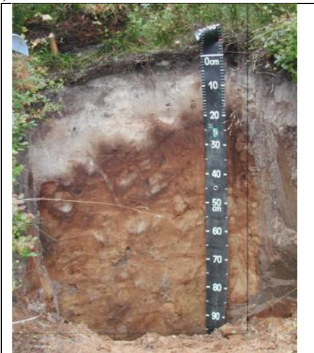
Fig. 1 : sur ce profil de sol, on distingue nettement de haut en bas : un horizon noir de matière organique mal décomposée, un horizon blanc de sable très pauvre, une roche mère en blocs, colonisée par les racines des arbres. (photo : B. Jabiol)
