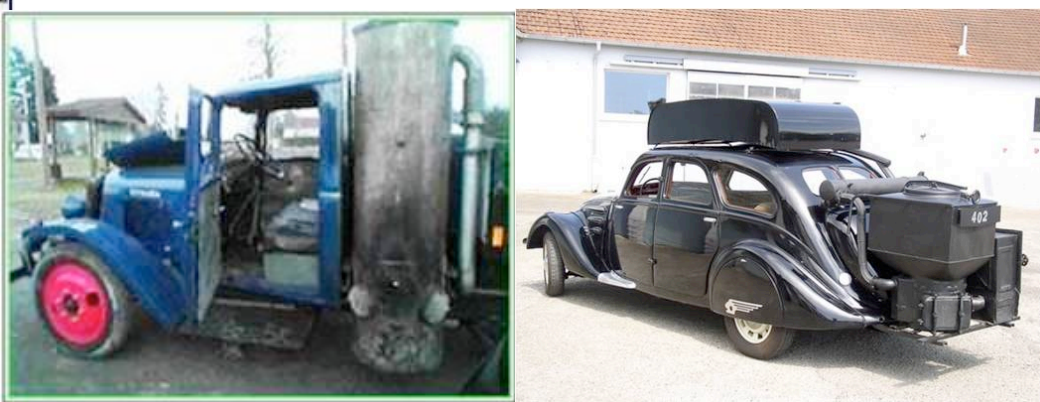
Figure 2. Quelques gazogènes sur véhicules
