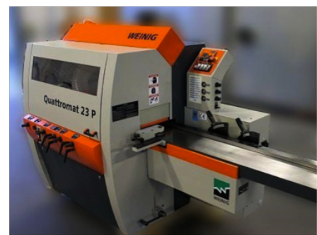
Figure 13. Corroyeuse moulurière - Source : Weining
