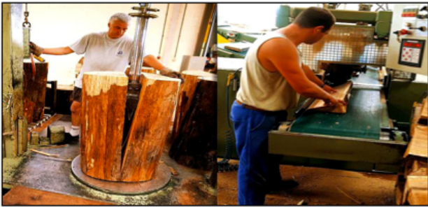
Figure 10. Des merrains aux douelles
