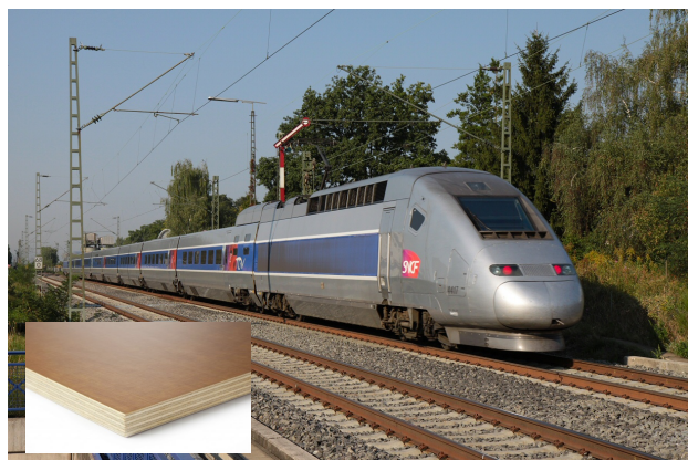
Figure 9. Plancher du TGV en contreplaqué multiplis
