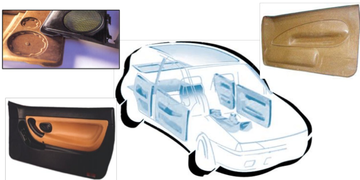
Figure 8. Parties de véhicule en fibre de bois
