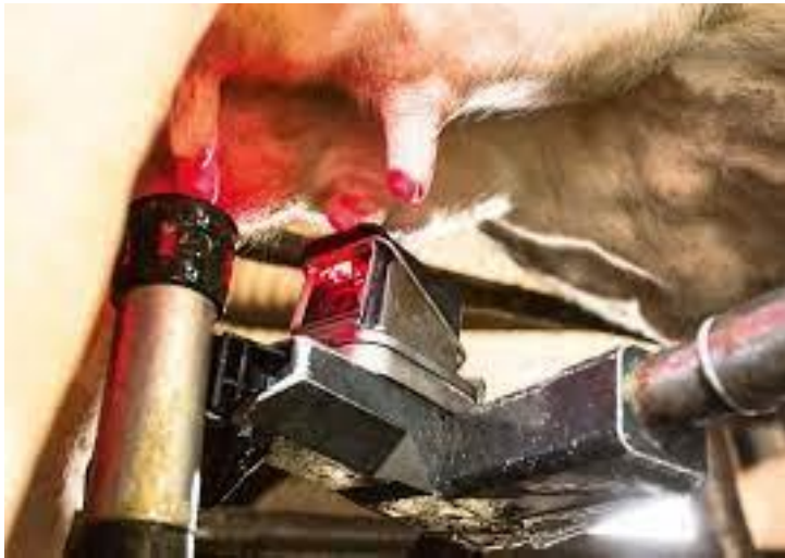
Détection laser des trayons
